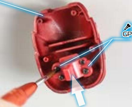
1 - В корпусе шарнира из выпуска 88 остались свободные отверстия для винтов. Вставьте в них два винта GP и слегка закрутите, чтобы было проще установить корпус на свое место. Поместите корпус внутрь защиты шеи (89A) и крепко закрутите винты.
